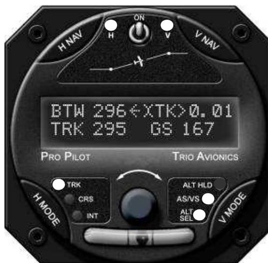
Une fois sortis de l'espace aérien de classe B, il est uniquement nécessaire de presser le bouton de l'encodeur pour initier de nouveau l'ascension. A ce point, la LED ALT HLD s'éteint et les LEDs AS/VIS et ALT SEL commencent à clignoter de nouveau, indiquant que l'altitude est en voie d'atteindre l'altitude présélectionnée.
