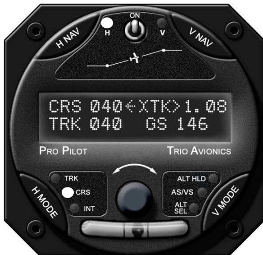
Dès que le contrôleur demande un virement 040 degrés (auparavant 010 degrés), un virement de 30 degrés sur la droite est requis. Le CRS désiré est dévié de 040 degrés, l'**ENCODEUR ROTATIF** doit donc être tourné dans le sens des aiguilles d'une montre jusqu'à ce que 040 soit affiché comme valeur CRS. Le Pro Pilot tournera l'appareil jusqu'à ce que la route (TRK) et le parcours (CRS) soient identiques (040).
