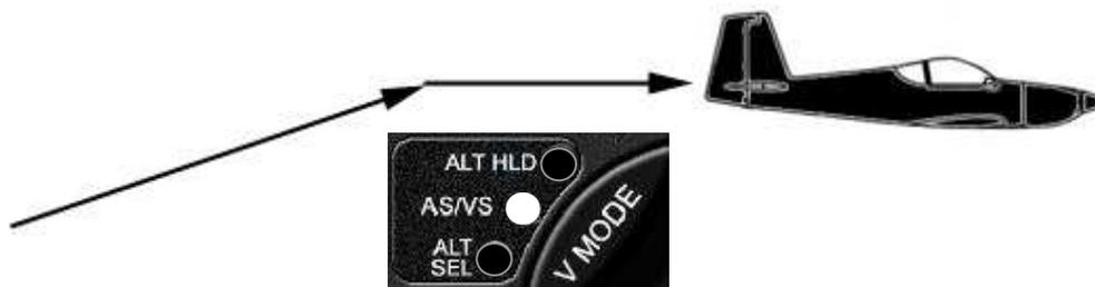
Réglez la vitesse d'ascension ou de descente en tournant le bouton de l'encodeur. Pressez le bouton de l'encodeur pour l'initialisation.
