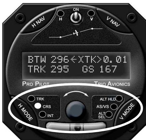
**⚠** Presser et maintenir le bouton NAV H pendant 3 secondes offre également la "automatique renversement de la Course" qui rend le servo des ailerons modification des paramètres pour réaliser un 180 degrés de virage à gauche pour un cours inverse à celui initialement établi. Voir page 31 pour obtenir des instructions sur la façon d'utiliser cette fonction.
