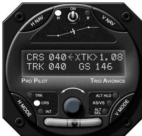
Sachant que le mode la trajectoire GPS (TRK) est en général sélectionné, pressez le bouton poussoir H MODE pour changer la LED H MODE et afficher le mode parcours (CRS).
