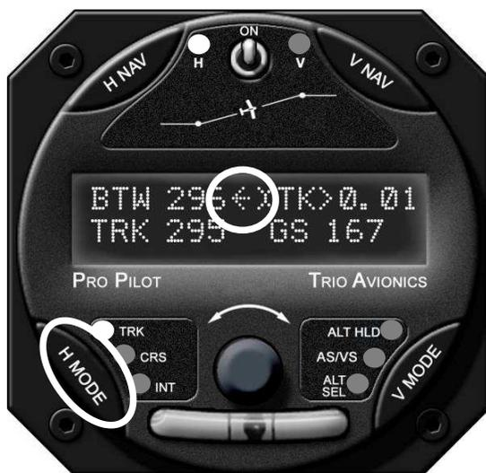
Cela indique que le servo de roulis a été activé en pressant le bouton H NAV et que le Pro Pilot indique la navigation horizontale, avec contrôle des axes de roulis de l'appareil.
